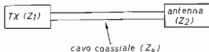
Schema di trasferimento di potenza (a RF) dal TX all'antenna mediante cavo coassiale.
