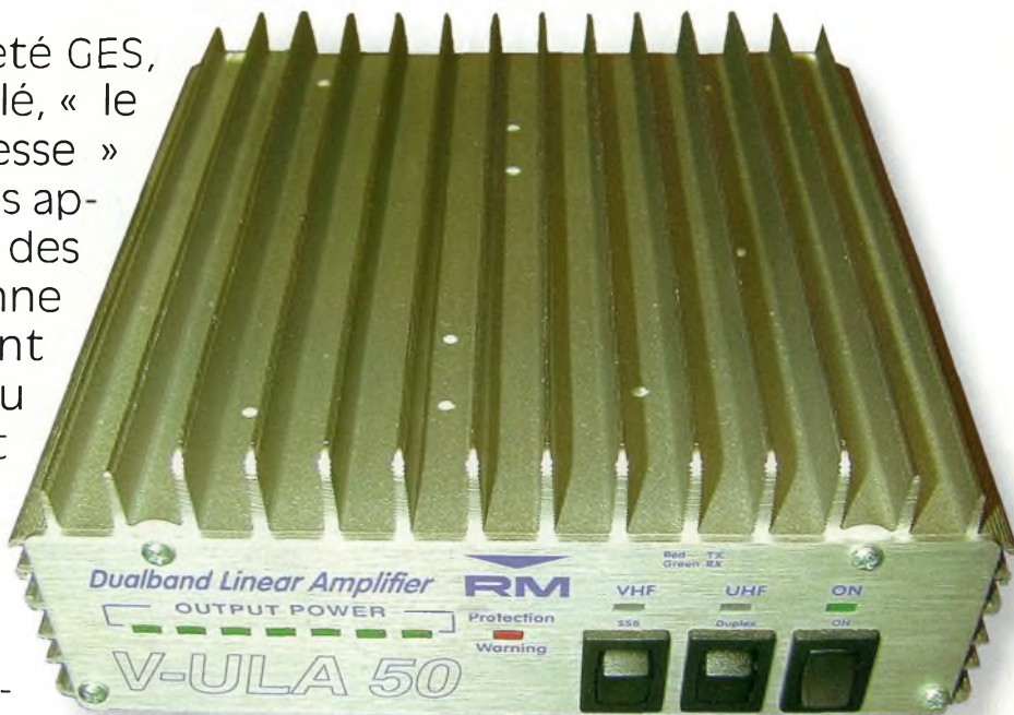
La face avant, sobre mais complète, quoi qu'un commutateur de mise hors service des préamplificateurs eut été le bienvenu.
