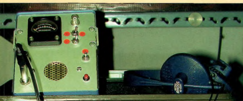
Le récepteur de gonlogométrie de F6AQN, c'est une réalisation personnelle.
