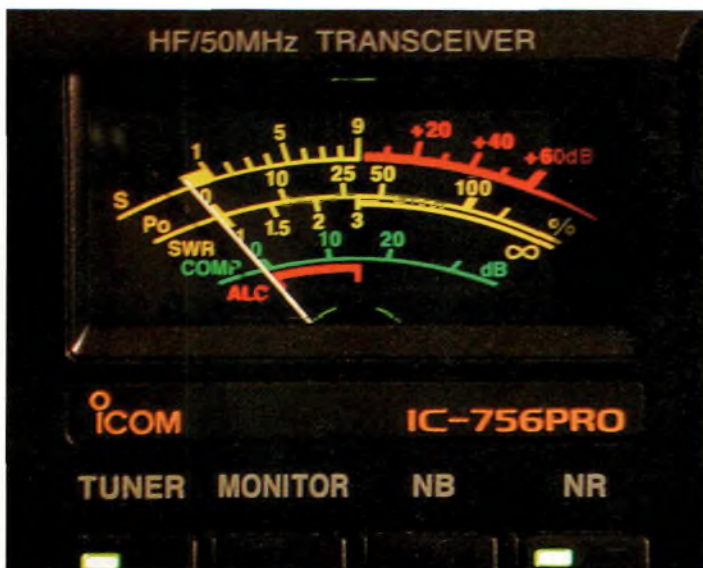
Fig.1- Malgré l'apparition des technologies modernes, il reste encore quelques rares transceivers haut de gamme qui disposent d'un Smètre à aiguille.
