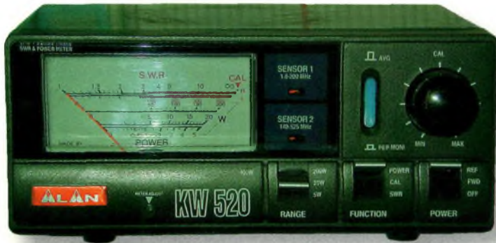
Le rosmètre-wattmètre à simple aiguille, nettement moins pratique que les modèles à aiguilles croisées.
