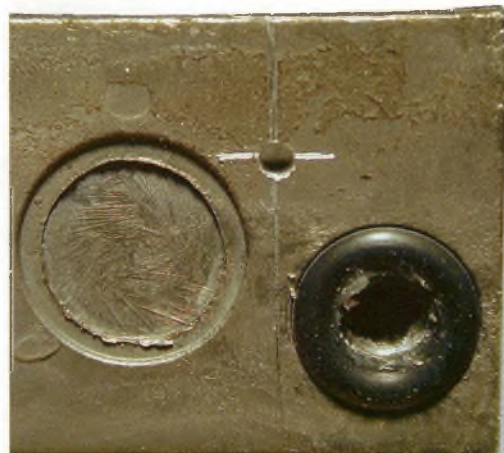
Un bon repérage avant de percer le trou.
