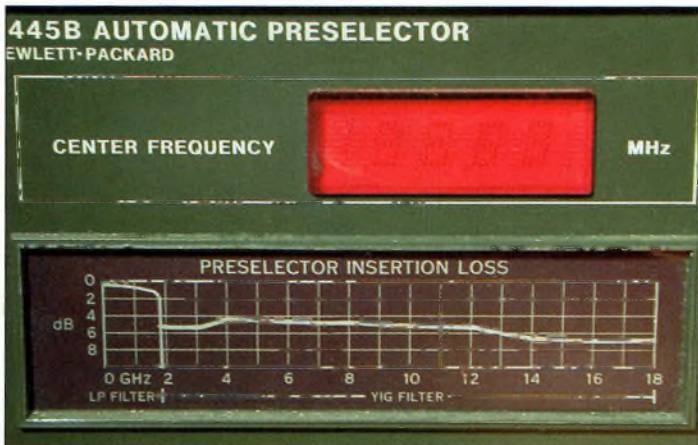
L'afficheur numérique du présélecteur devient fort utile quand l'aiguille du tiroir 8555A est cassée !
