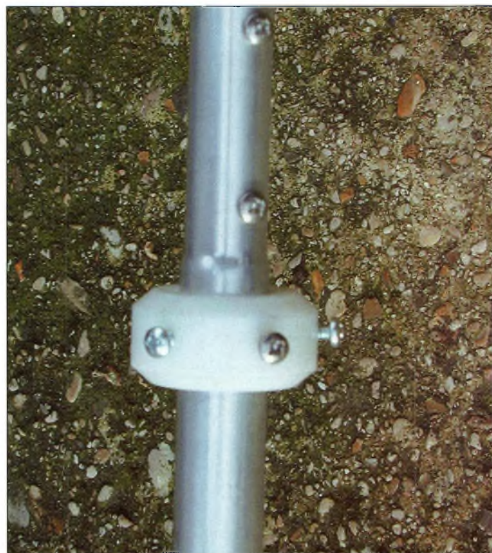
La mise en place de la bague en Nylon et la fixation des tubes entre eux.
