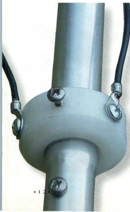
La bague en Nylon maintient les trois fils sur la partie supérieure de l'antenne.
