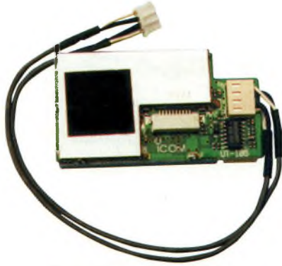
Photo C : Des modules DSP optionnels comme ce UT-106 pour un ICOM IC-718 sont chouettes parce qu'ils sont vite installés dans le coffret du transceiver et augmentent vraiment les performances.
