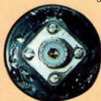
La fiche PL est ensuite maintenue avec des vis parker et un peu de colle époxyde.
