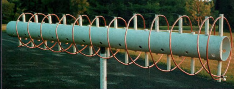
Un prototype de l'antenne hélice conçue par Mike Cook, AF9Y, faite d'un tuyau en PVC et d'un tube en cuivre qui pourrait vous aider à vous accorder sur le test d'émetteur de l'orbiteur de Mars. Les détails et les instructions pour la construction se trouvent sur le site de Mike (voir encadré). (Photo : Mike Cook, AF9Y)
