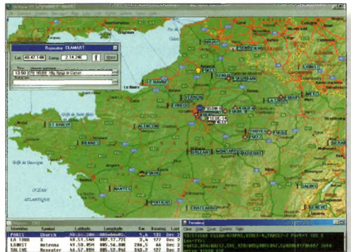
Fig.1- Avec l'option "Objectif" on peut depuis sa station "simuler" la position d'éléments comme la liste de certains relais Français VHF ou les positions de Radio-Club. En cliquant sur l'une de ces icônes Exemple 'CLAMART' une fenêtre s'ouvre et un commentaire donne les caractéristiques de celui-ci, etc...
