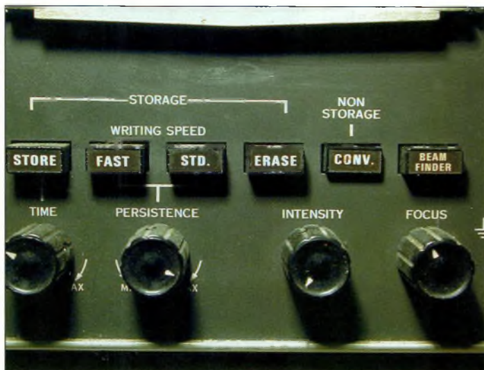
Pour bien faire, essayez d'opter pour une base HP 141 T dotée d'une mémoire d'écran analogique. Dans ce cas, essayez impérativement l'appareil car certains écrans sont brûlés à cause de cette option.
