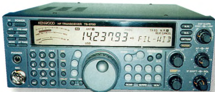
Photo A : Les capacités DSP sont des caractéristiques intégrées ou optionnelles dans un nombre croissant de transceivers. On les utilise pour réduire le bruit de bande (NR), effacer les tons de battement (BC) et éviter le QRM en variant l'inclinaison du filtre passe-bande (Inclinaison DSP). Certains systèmes DSP opèrent au niveau FI alors que d'autres opèrent au niveau AF. Ils fonctionnent tous à merveille !
