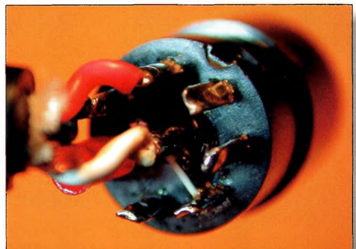
Les modifications à faire pour utiliser le SM-6 avec un FT847, notez bien la résistance CMS de 510 ohms qu'il faut rajouter pour alimenter l'électronique.
