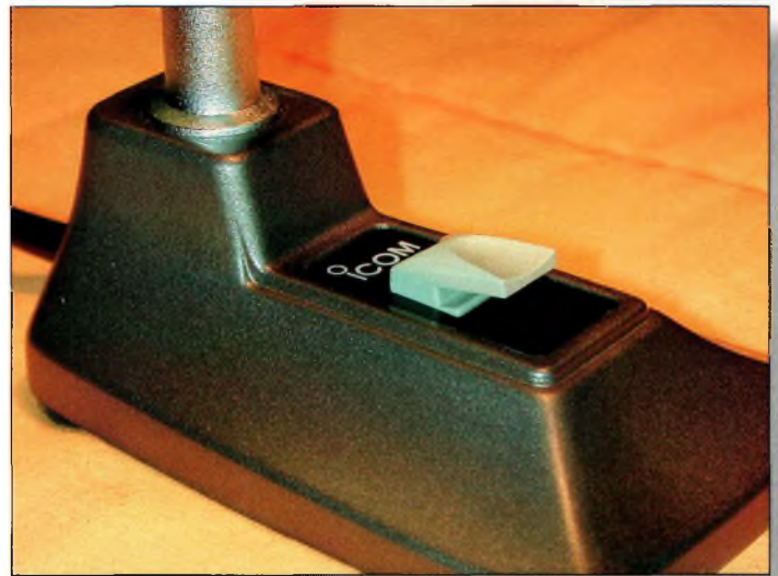
La pédale du micro peut se bloquer en la tirant vers soi.
