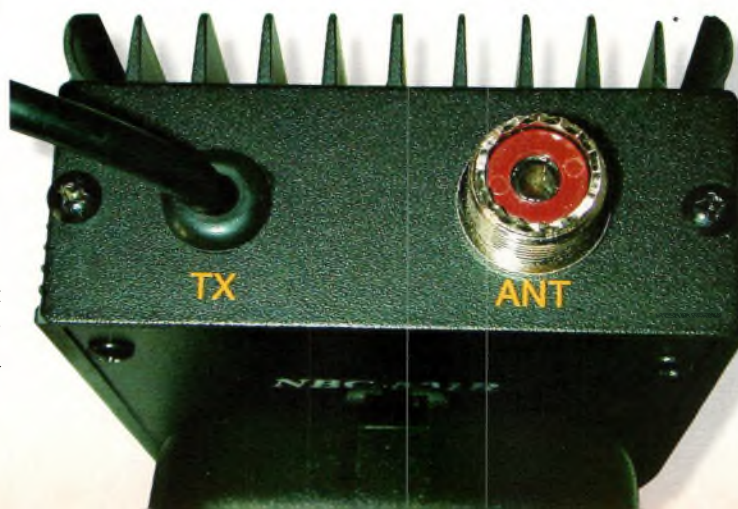
L'entrée se fait par un cordon BNC, la sortie sur une prise SO-239.
