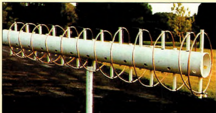
Mike Cook, AF9Y, propose sur son site < http://www.webcom.com/af9y/helix.htm >, la description d'une antenne hélice confectionnée à partir d'un tube PVC et un tube de cuivre récupéré sur un vieux réfrigérateur.
