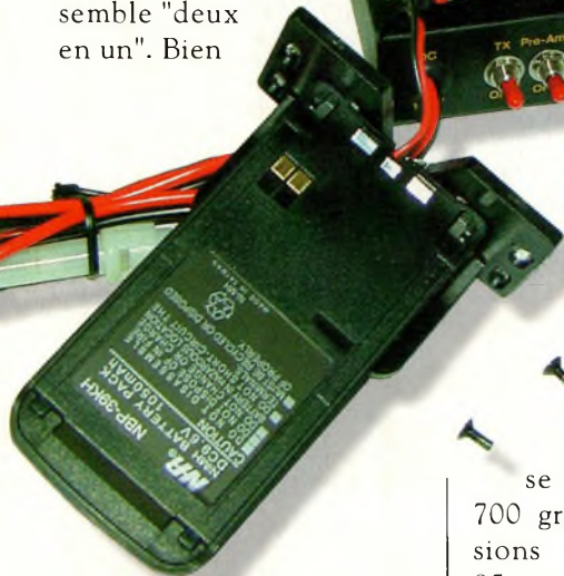
La mise en place du sabot par l'intermédiaire de quatre vis de fixation.
