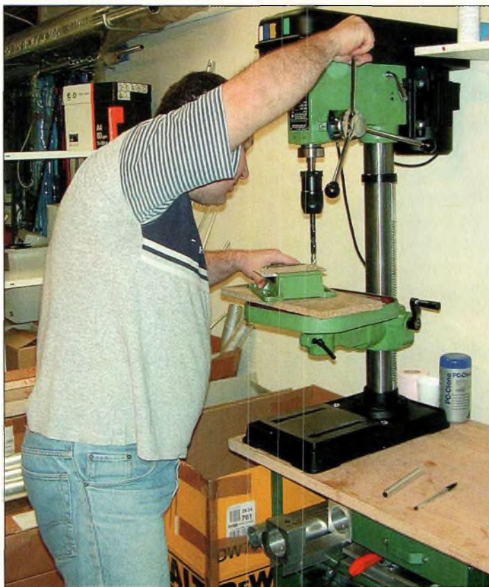
Le perçage des plaques est un travail de précision, et pour certaines d'entre elles, on utilise des gabarits adéquats. Ils assurent une reproductibilité parfaite d'une antenne à l'autre. Le perçage des tubes suit le même processus.
