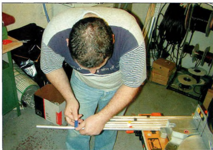
Le repérage des éléments et des pièces qui leur correspondent se fait avec des anneaux de couleurs.
