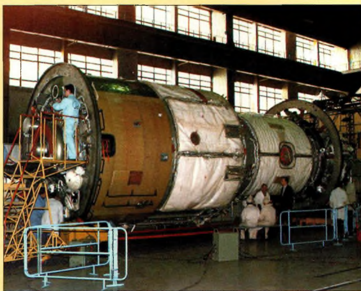
Le module de service russe destiné à la Station spatiale internationale (ISS) en cours de construction. C'est précisément dans ce module que sera installée la toute première station radioamateur, RZ3DZR. (©NASA).
