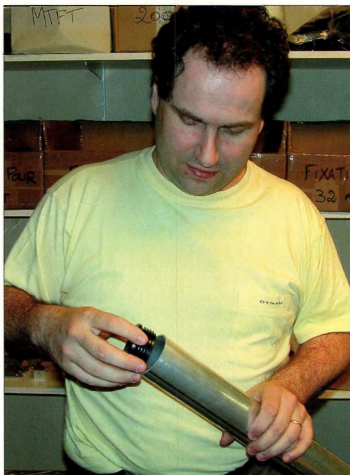
Après le découpage des tubes et le contrôle, on pratique un ébavurage intérieur puis on place un bouchon en plastique.
