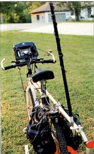
Photo 3- Cette vue de derrière montre l'antenne Outbacker, son support et le tube d'extension.
