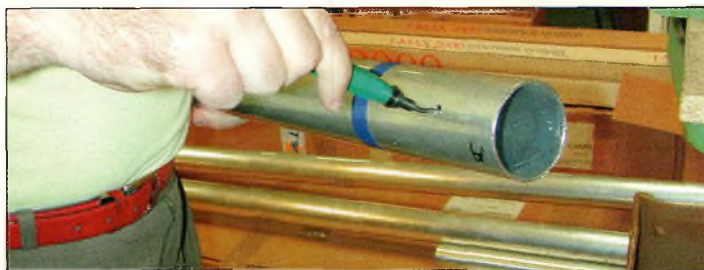
Le moindre trou est ébavuré pour assurer une finition de qualité.
