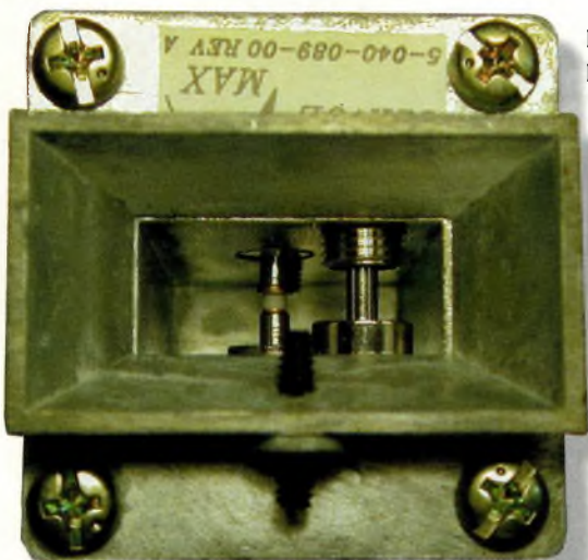
La cavité Gunn, quoi de plus simple pour faire de l'émission sur 10 GHz. A découvrir bientôt dans votre magazine.
