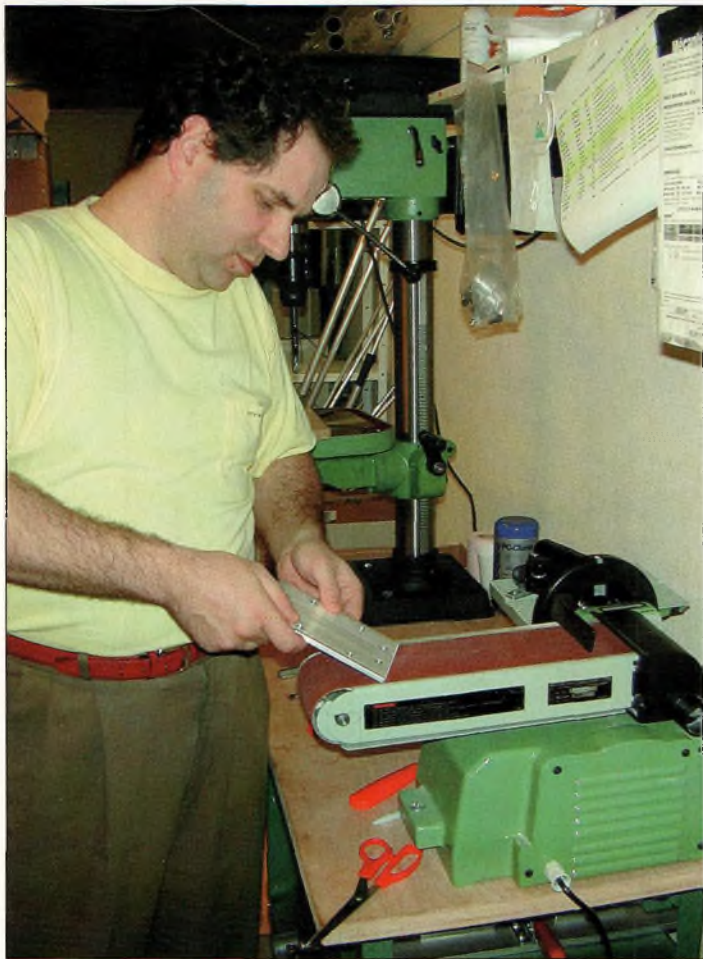
Après les opérations de perçage, c'est la phase d'ébavurage. On obtient ainsi des pièces d'une très belle qualité de finition.
