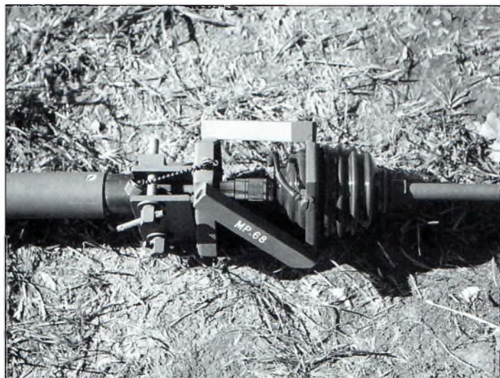
L'embase MP-68 vient se fixer sur le mât et le coaxial (fourni) si glisse à l'intérieur.
