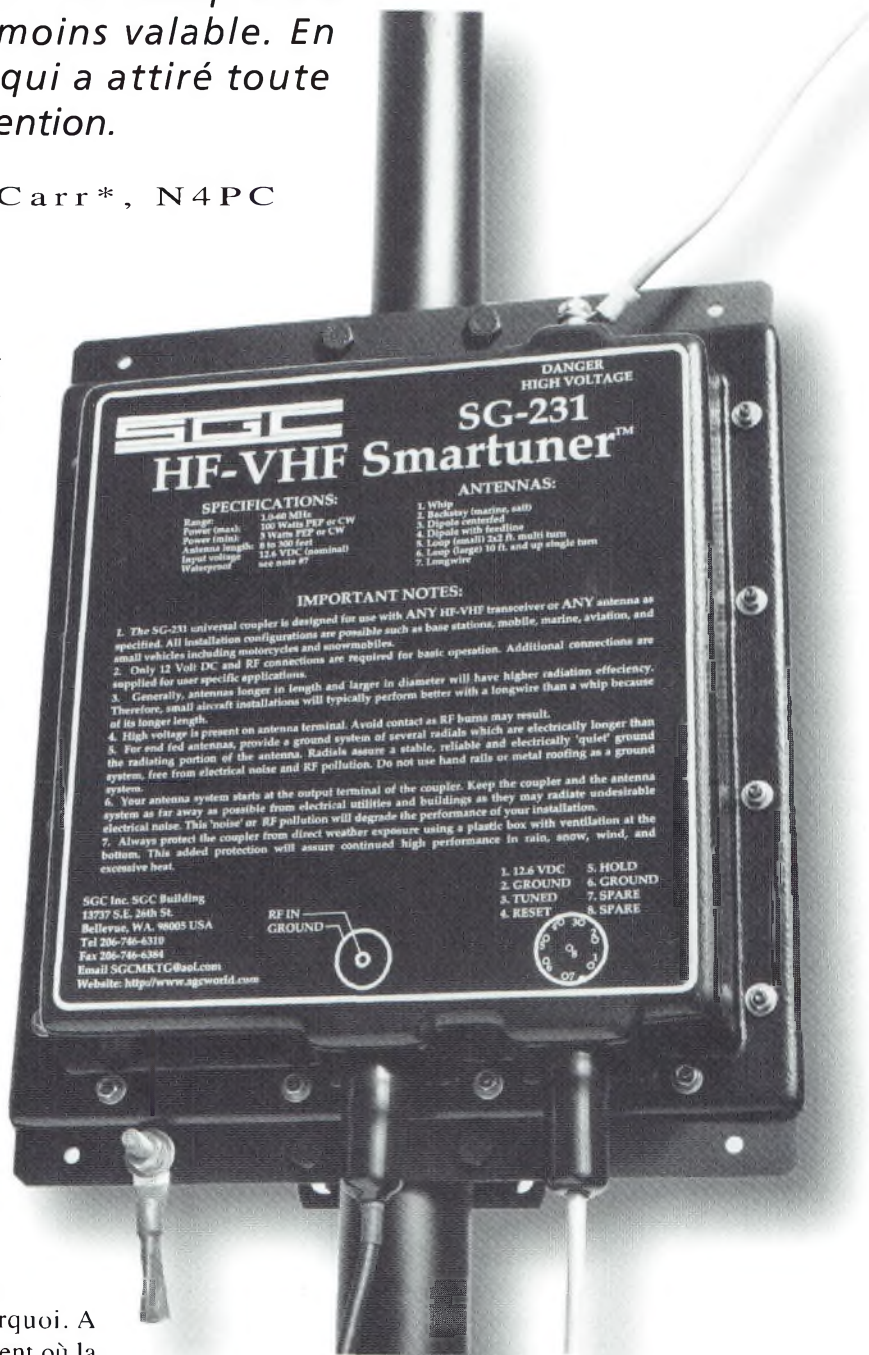
Le SGC SG-231 Smartuner est un coupleur automatique contrôlé par microprocesseur.
