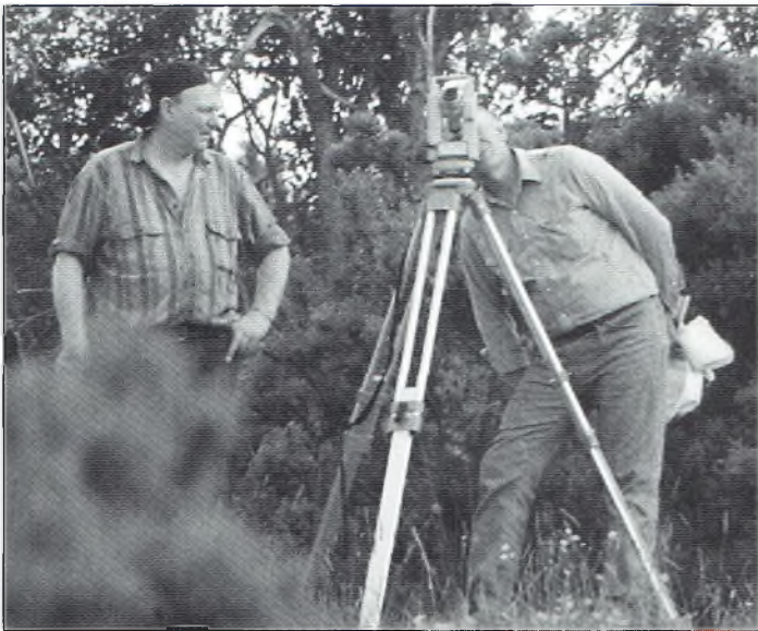
GIØTHZ et K5IU repèrent le pylône à l'aide du théodolite.
