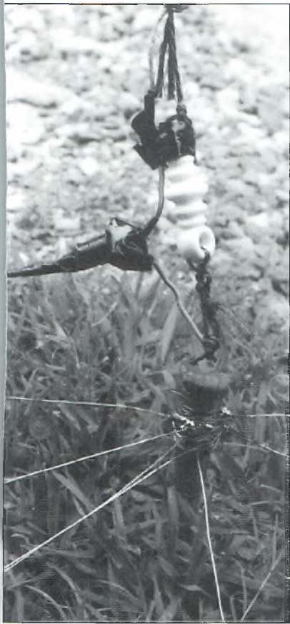
C'est simple et, par-dessus tout, ça fonctionne. Voici le point d'alimentation de l'antenne L-inversé pour le 160 mètres.
