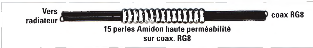
Fig. 6— Schéma du balun 1:1.
