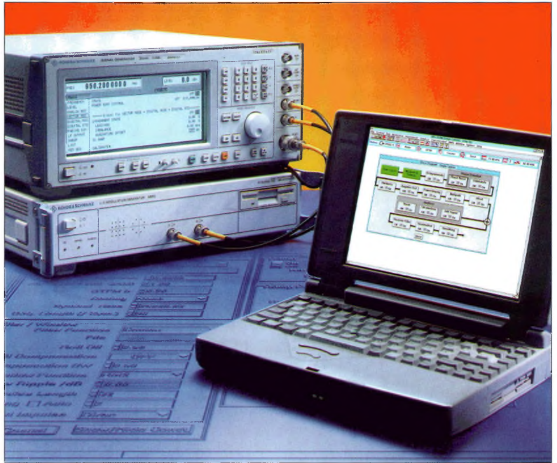
Le générateur de signaux I/Q, type AMIQ, de Rohde & Schwarz, offre des possibilités innovantes pour la génération de signaux large-bande, comme le W-DCMA, et de signaux multiporteuses.
