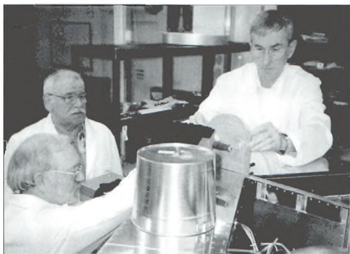
Stan Wood, WA4NFY (à droite), procède à l'équilibrage très précis de Phase-3D dans son berceau. W5DID (à gauche) et DG7FDQ (au premier plan), assistent attentivement à l'opération. Le «pot de peinture» à l'envers est l'une des antennes 10 GHz du satellite.
