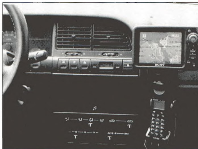
Système d'aide à la conduite automobile avec localisation par GPS.
