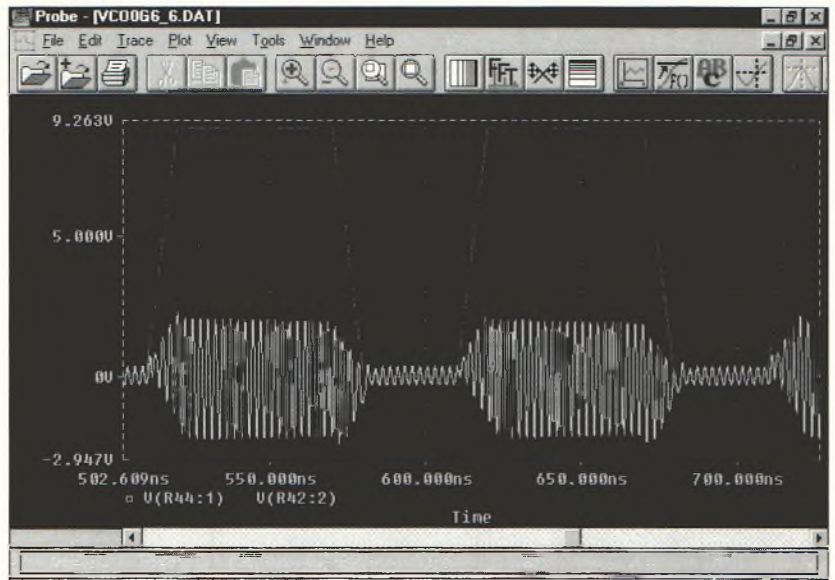
Fig.2 — Les signaux sont d'égales amplitudes mais de phases opposées.
