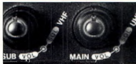
Généralement placées sur le dessus de l'émetteur-récepteur, les commandes de volume et de squelch peuvent être indépendantes pour la VHF et l'UHF si l'appareil est de type bibande.
