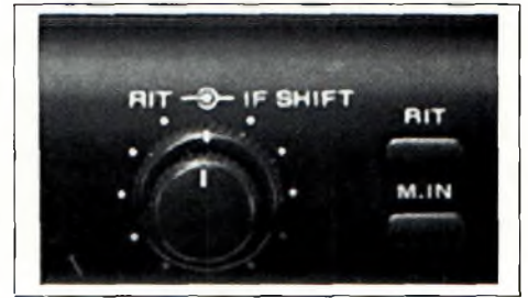
Le RIT (Receiver Incremental Tuning) permet de décaler la fréquence de réception sans déplacer la fréquence d'émission.
