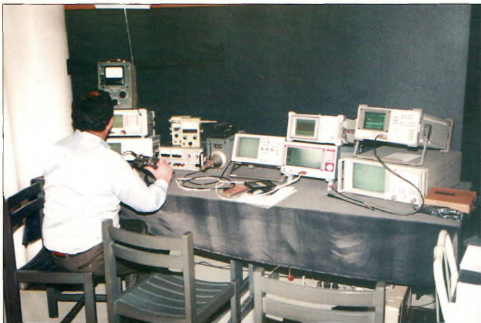
Le laboratoire de mesures de l'IDRE, où François Lambert, F6AJL, teste les transceivers qui lui sont amenés par les OM. Fournissant une précieuse fiche des mesures effectuées avec des appareils sophistiqués, aimablement prêtés par Hewlett-Packard, Marconi Instruments SA et Rohde & Schwarz, le laboratoire connut son succès habituel tout en confirmant le côté expérimental du service Amateur.
