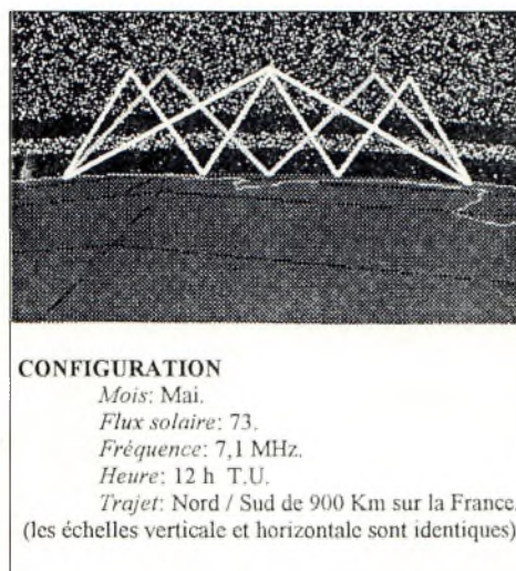
Figure 1. Trajet des ondes par 1, 2 ou 3 rebonds sur la couche F de l'ionosphère.
