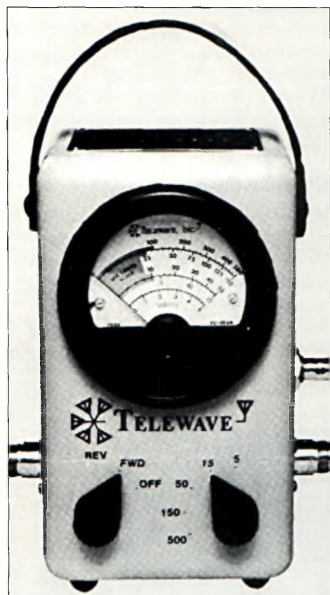
Le wattmètre est un appareil de mesure fort utile
