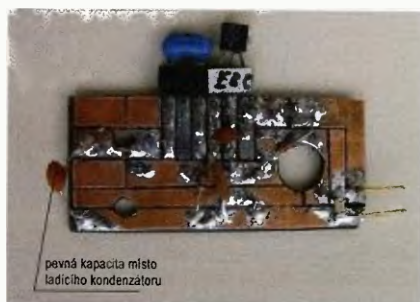
Obr. 7. Praktická realizace oscilátoru z obr. 6
