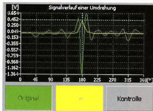
Obr. 3. Průběh jedné otáčky indikace svaru - na monitoru jednotky SND40
