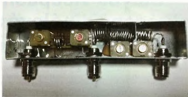
Obr. 8. Diplexer ve stíněné krabici
