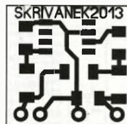
Obr. 4. Deska s plošnými spoji INV1 (2 : 1)
