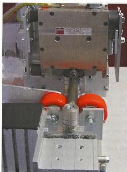
Obr. 2. Indikace svaru trubky - snímač NS12
