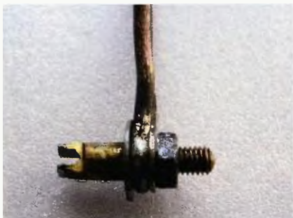
Obr. 1. Úprava smyčky pistolové páječky pro odpájení SMD tranzistorů
