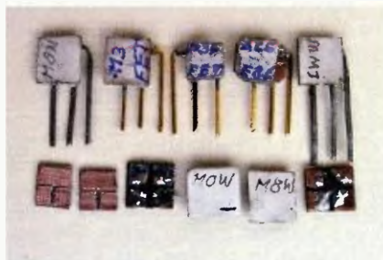
Obr. 2. Destičky s připájenými SMD tranzistory
