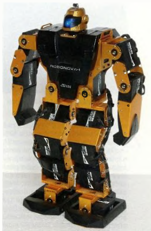
Obr. 25. Robot Robonova-1 není nic jiného, než 16 pospojovaných robotických serv, akumulátor a řídicí jednotka
