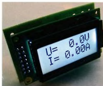
Obr. 7. Fotografia kompletného meracieho panelu
