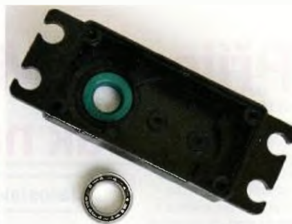
Obr. 33. Náhrada horního ložiska v krytu guferem
