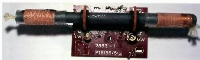
Obr. 95. Typická feritová anténa v rádiovém přijímači
