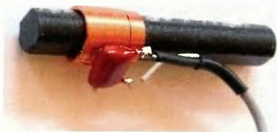
Obr. 94. Feritová anténa 10 x 50 mm, kondenzátor nastavuje rezonanční kmitočet (v tomto případě 77,5 kHz pro příjem časového signálu DCF)
