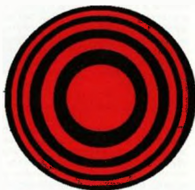
Obr. 3. Schéma záření FZP antény s označením hlavních rozměrů. Z propustných (červených) kruhových zón FZP antény se v ohnisku F_0 sečtou jen vlnové paprsky se stejnou fází
