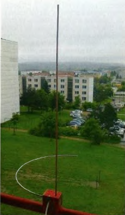
Obr. 2. Upravená verze „všesměrového kruhového“ půlvlnného dipólu. Je nejjednodušší FM anténou na balkóny i okenní rámy, kompromisem mezi kusem drátu a „velkými“ anténami. Délka prutu i obvod půlkruhu jsou \lambda/4 , čili asi 75 cm. Na balkoně či lodžii ji lze snadno umístit do prostoru nejlepšího příjmu žádané stanice a s kvalitním tunerem umožní dobrý příjem signálu od asi několika desítek mikrovoltů (36 dB), s výjimkou velkého fázového zkreslení, což však platí pro veškerý městský příjem mimo střechy nejvyšších budov. Chceme-li oddělit dvě stanice s různou polarizací, vysílající na stejném kmitočtu (k čemuž potřebujeme tuner s velmi nízkým výběrovým poměrem), použijeme raději celý přímý dipól s příslušnou H nebo V orientací. I takovéto „hračky“ dávají překvapivě dobré výsledky, celovlnnému čtverci se ale nevyrovnají
