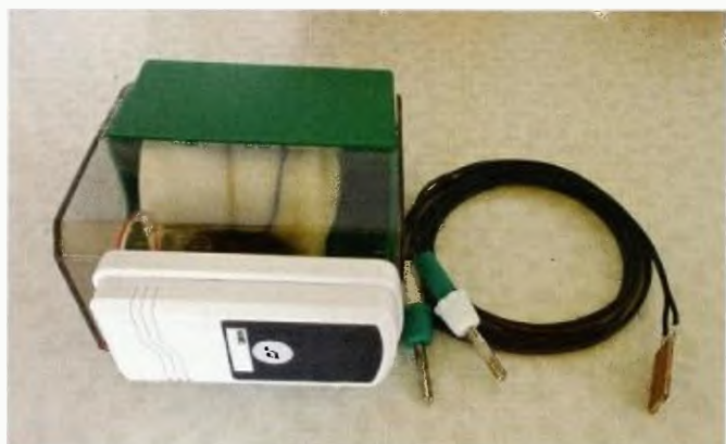
Obr. 3 a 4. Připojení tlačítka a desky snímací a spínací části přípravku
