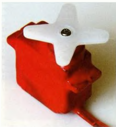
Obr. 32. Servo obalené tekutou gumou Plasti Dip
