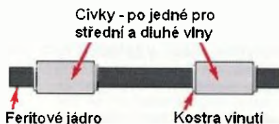
Obr. 94. Feritová anténa 10 x 50 mm, kondenzátor nastavuje rezonanční kmitočet (v tomto případě 77,5 kHz pro příjem časového signálu DCF)
