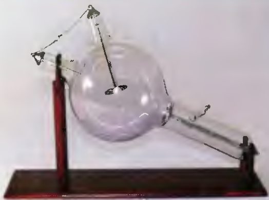
↑ Rentgenka – elektronka, jejíž anoda je zdrojem rentgenového záření ⇒ Vysílací elektronky německé firmy Telefunken
