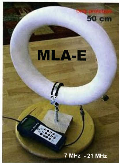
Obr. 5. MLA-E s anténním analyzáteorem
