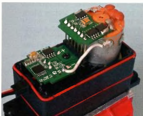
Obr. 24. Těsnění gumou mezi díly krytu maxiserva
