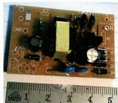
Obr. 4. Deska zdroje 6 V
