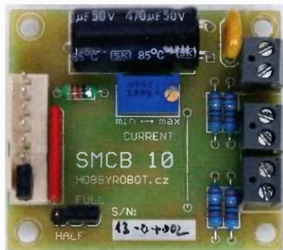
Obr. 2. Deska s plošnými spoji a fotografie SMCB10
