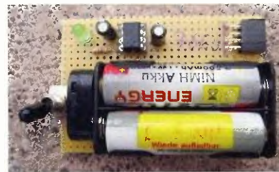
Obr. 8. Menič s ICL7660 na univerzálnej doske
