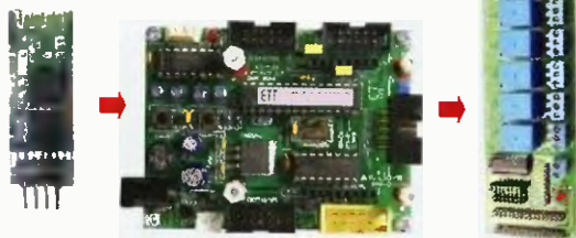
Zapojení pro dálkové spínání vznikne propojením tří modulů – Bluetooth modulu HC 05, mikropočítače Arduino a desky s relé
