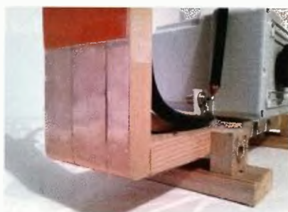
Obr. 13. Pohled na Cu pásky a vazební smyčku
