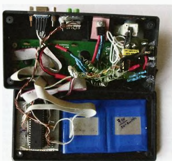
Obr. 2 až 4. Hotový přístroj, pohled na programovací konektor a tlačítka, sonda s GM trubicí a vnitřní uspořádání přístroje
