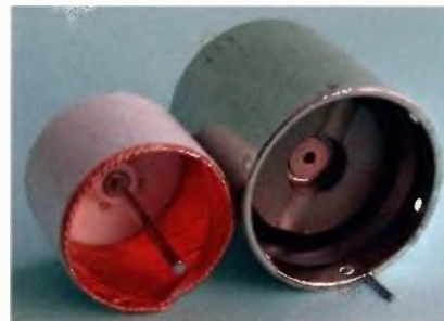
Obr. 6. Rotor a plášť s vnitřním magnetem „coreless“ serva
