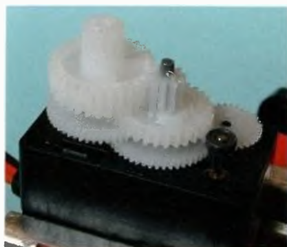
Obr. 9. Plastová převodovka i pastorek v mikroservu
