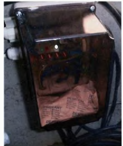
Obr. 7. Krabice řídicí elektroniky se silikagelem
