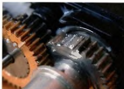
Obr. 12. Vylámané zuby kovového unašeče po rázu
