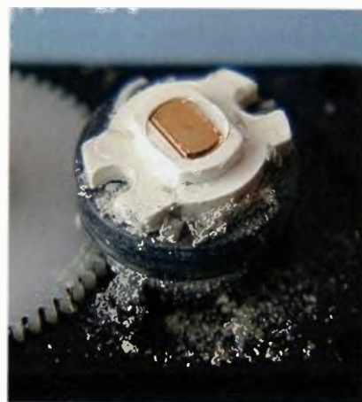
Obr. 11. Otěr v třecím uložení nahoře potenciometru
