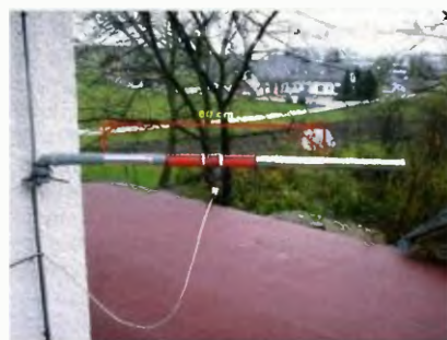
Obr. 4. Horizontální montáž antény pro pásmo 20 m. Zde si můžeme všimnout praktického využití již zmíněných vodoinstalačních trubek a tvarovek
