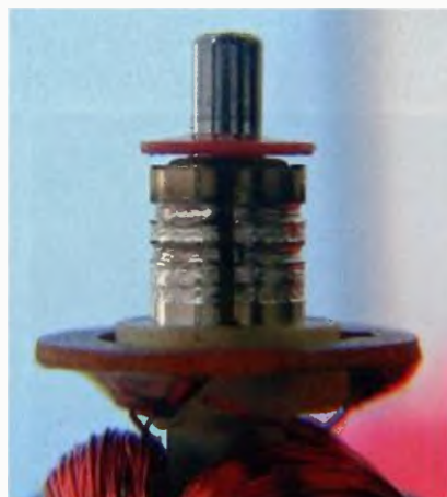
Obr. 7. Značně opotřebený komutátor z motoru serva FP-148
