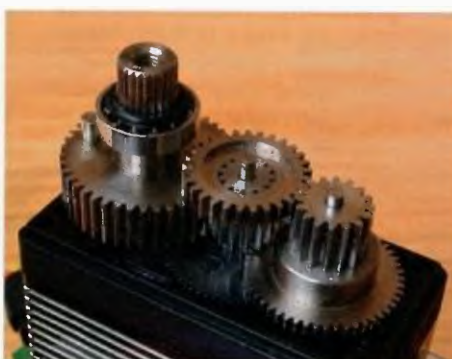
Obr. 10. Kovová převodovka většího serva
