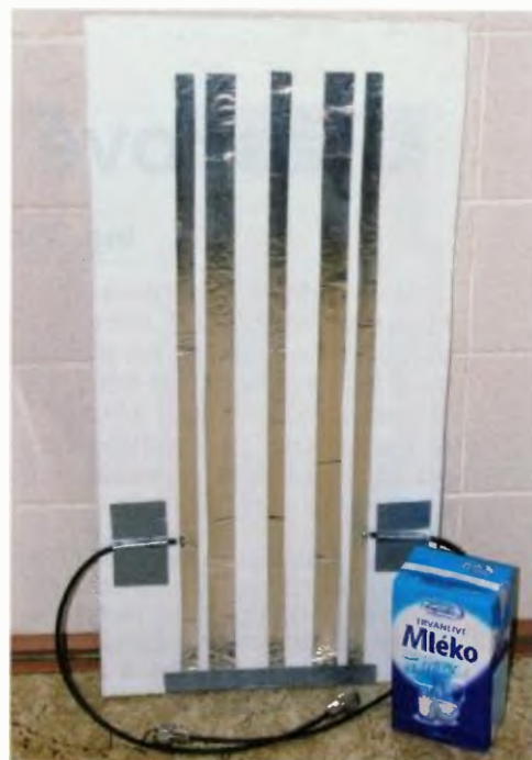
Obr. 4. Filtr 80 MHz s malou selektivitou
