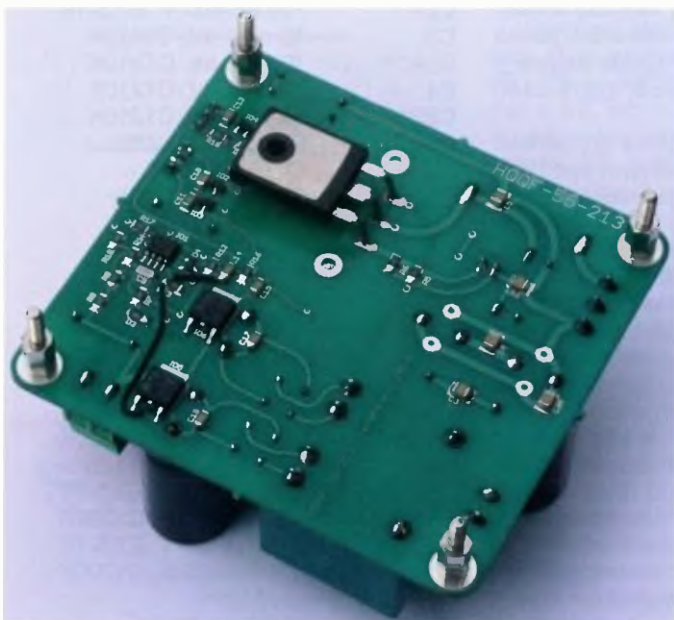
Obr. 12. Deska s plošnými spoji a fotografie hotové desky s tranzistorem na straně spoju
