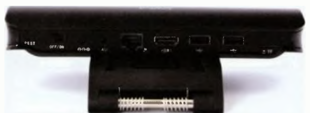
Na zadní straně počítače je RESET, vypínač, konektor napájení, výstup AV, RJ45 pro LAN, HDMI, 2x USB a slot pro microSD
