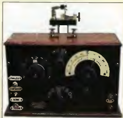
Obr. 15. Krystalka laděná přepínáním kondenzátoru, ale i otočným ladícím kondenzátorem
