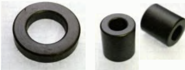
Obr. 3. Feritová jádra, vhodná pro konstrukci plášťových tlumivek
