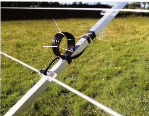
Obr. 2. Obvyklá a snadno reprodukovatelná provedení tlumivky s vyznačenými vlastnostmi
