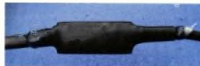
Obr. 3. Na konce kabelů jsem nanesl tavné lepidlo a zesilovač hermeticky zatavil do smršňovací bužírky
