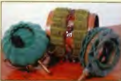
Obr. 9. Ladění pomocí variometru [2]
