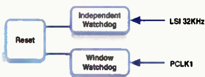
Obr. 27. Mikrokontrolér STM32 disponuje dvoma nezávislými watchdogmi
