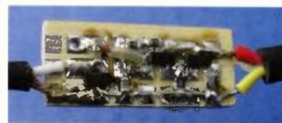
Obr. 2. Předzesilovač jsem postavil se SMD na kousku univerzální desky. Samozřejmě lze použít i klasické drátové součástky (1N4148 a BC548B)
