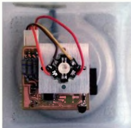
Obr. 11. Umístění elektroniky ve stínítku
