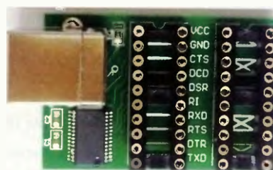
Obr. 26. Prevodník RS232 (TTL) na USB zo stavebnice Elektronik Start mit USB
