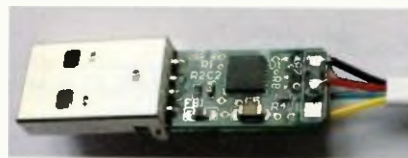
Obr. 25. Prevodník RS232 (TTL) na USB, ktorý je možné kúpiť ako modul a doplniť káblom s tromi zdierkami na piny RX, TX a GND dosky Discovery
