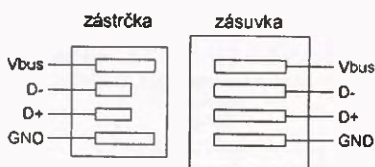
Obr. 2. Pripojenie USB portu
