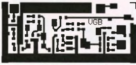
Obr. 11. Deska s plošnými spoji VGB (měřítko 1 : 1)
