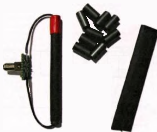
Obr. 4. Konstrukce napájecího oddělovacího transformátoru dle [1]
