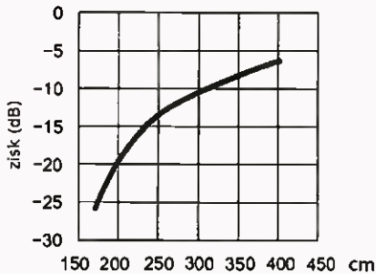
Obr. 6. Vliv umístění napájecího transformátoru na zisk antény
