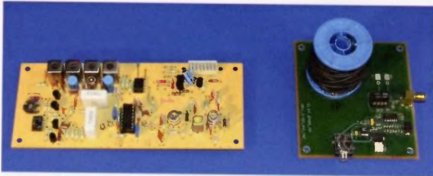
Obr. 2. Demodulátor B261 Revox a vzorek se zpořďovací linkou
