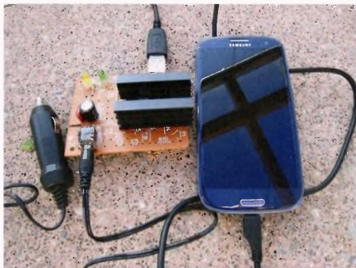
Obr. 6. Praktická realizácia nabíjačky z obr. 5
