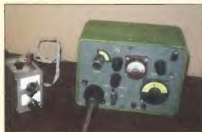
Obr. 1. Vľavo vysielateľ podľa Ing. Budíka, OK1AU, z marca 1938, vpravo sovietsky transceiver Sever
