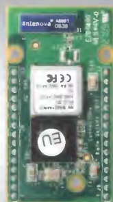
Nano Socket iWiFi™ 1.540,- Kč UART, SPI, USB WiFi: integrovaná anténa
