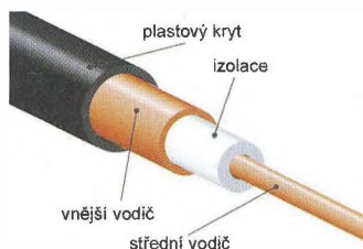
Obr. 8. Koaxiální kabel
