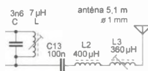
Obr. 9. Složení přizpůsobovací cívky k vysílači z minulého čísla
