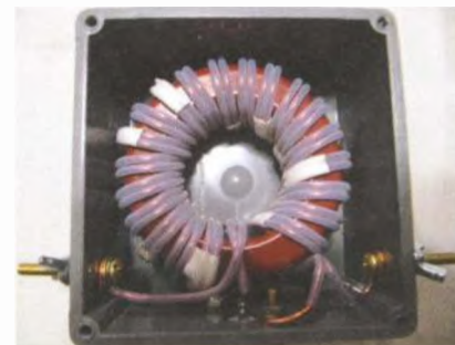
Obr. 6. Umlistění oddělovacího transformátoru ve vodotěsné skřínce
