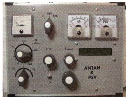
Obr. 5. Fotografie předního panelu vzorku analyzátoru s možností přeplnat mezi původním můstkem a měřičem PSV
