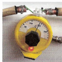
Obr. 27. Rezonance dvousmyčkové MLA s navlečeným toroidem, žárovka svítí minimálně
