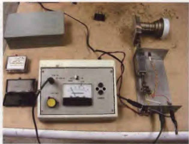
Sestava šumového přijímače: LNB, mf zesilovač „in-line“, detektor a operační zesilovač v otevřené krabici. V pouzdru s měřidlem je selektivní zesilovač 1 kHz a log. převodník s NE567
