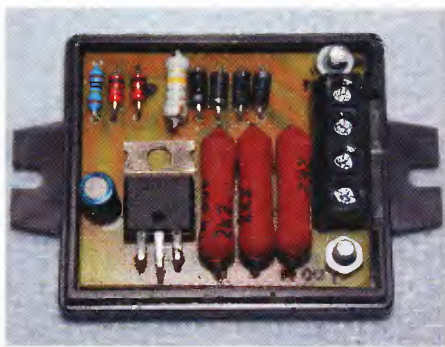
Obr. 4. Obvod pre pomalé rozsvietenie žiarovky
