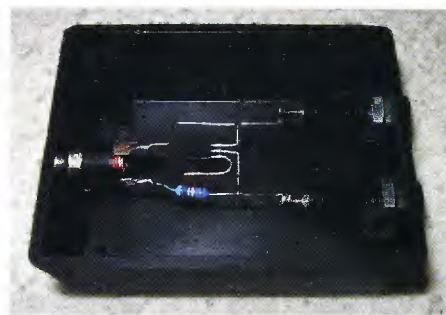
Obr. 7. Montáž součástek ss kalibrátoru do plastové skříňky
