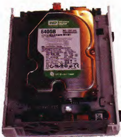
Po jednoduchém sejmutí krytu DS110j se do připraveného prostoru čtyřmi šroubky připevní pevný disk
