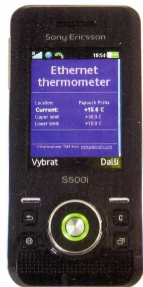
Údaje teploty z ethernetového teploměru TME lze přímo zobrazit i v mobilním telefonu nebo PDA
