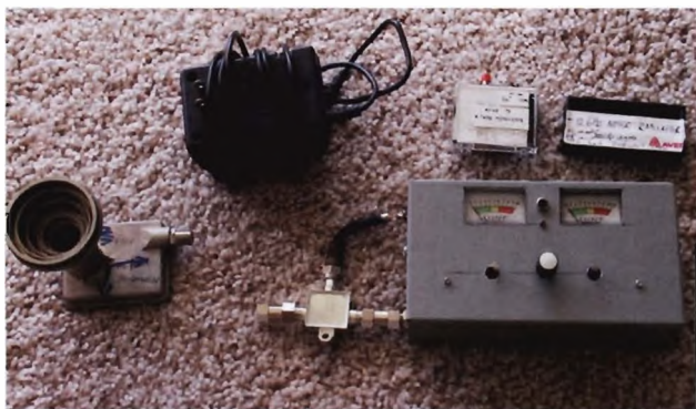
Obr. 12. Součásti polarimetru RPL-11: LNB, napájecí zdroj, skříňka obsahující vše z obr. 9. Pro seřizování se s výhodou použil šumový zářič s modulovaným zdrojem (dvě krabičky nahoře)
