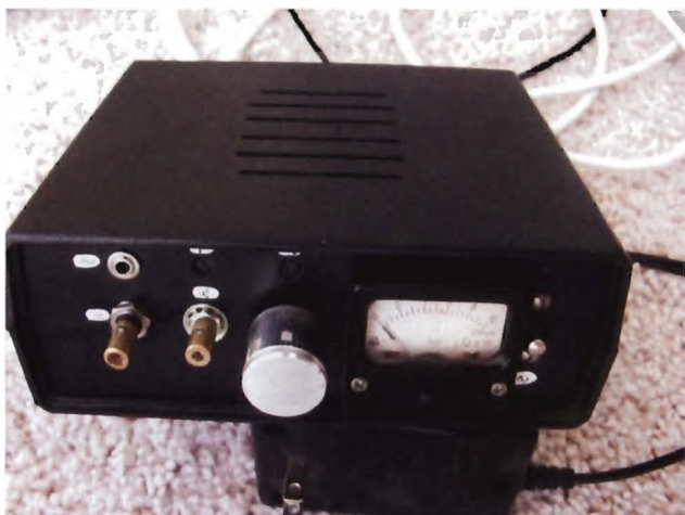
Obr. 16. Dickeho radiometr – pohled na přední panel
