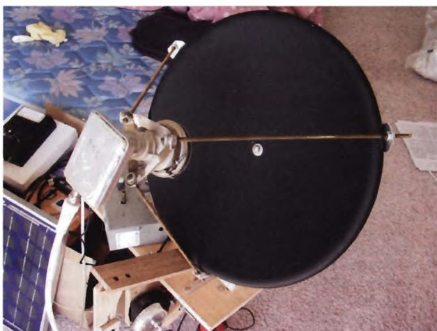
Obr. 13. Polarimetr se skenovacím mechanismem: excentricky upevněný bubínek na ose motoru s převodem kývá anténou vsvisle asi 2x za minutu v rozmezí asi 10°
