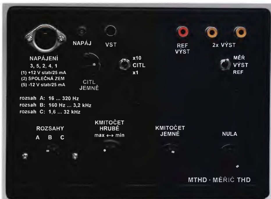
Obr. 9. Pohled na panel měřiče THD
