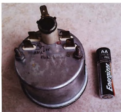
Obr. 33. Palivoměr - poměrový elektromagnetický systém
