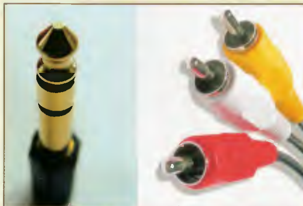
Obr. 8 (Vlevo) Populární mikrofon model 44, i pohled dovnitř Obr. 9. RCA jack konektor 6,3 mm a stále používaný RCA konektor zvaný také „cinch“ (dole)
