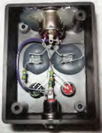
Obr. 9. Uspořádání součástek ve skřínce testeru
