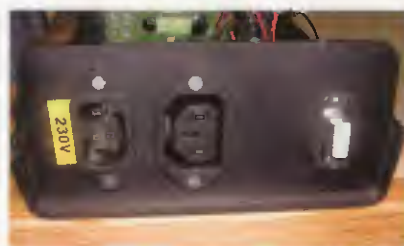
Obr. 6. Zadní panel řídicí jednotky s konektory
