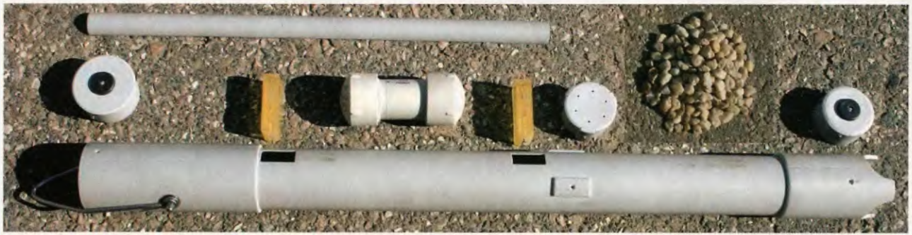
Obr. 10. Díly plovákové komory a hotová komora s kabelem
