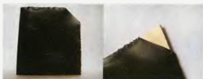
Obr. 5. Ochranná fólie s ustříženým rohem a DPS v ní zasunutá
