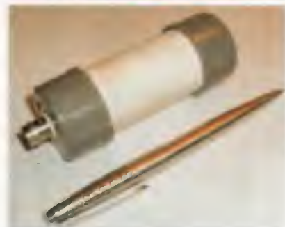
Obr. 5, 6. Praktické provedení antény Mini-Whip. Obrázky jsou převzaty z internetových stránek YU1LM [5]
