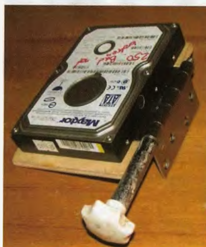
Základní součásti a konstrukce gyroskopického stabilizátoru s jedním diskem
