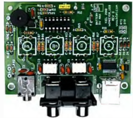
Obr. 7. Osazená deska s plošnými spoji. Vše je na desce včetně tlačítek, drátové připojení je použito jen v nezbytné míře
