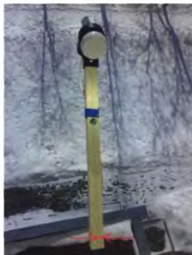
Nasměrování satelitní antény pomocí stínu, vrženého Sluncem v okamžiku stejného azimutu Slunce a satelitu
