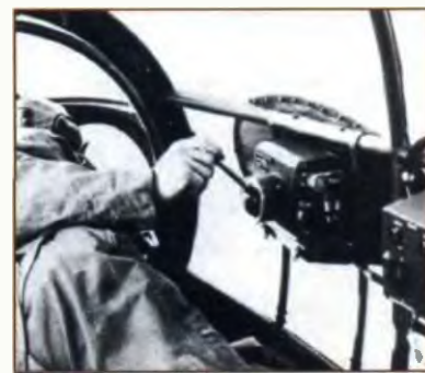
Obr. 15. Dálkové ovládání FuG 203b „Kehl III“ (Heinkel 111)
