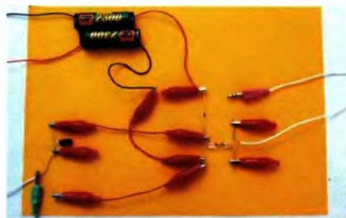
Obr. 42. Pokusné zapojenie s LED a fotodiódou
