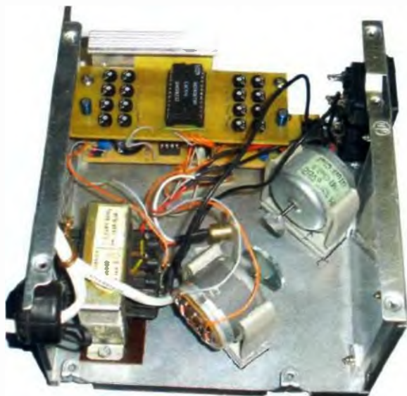
Obr. 4 a 5. Doska s plošnými spojmi multiplexeru a jej osadenie
