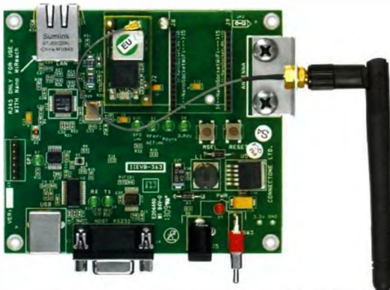
Pro pohodlnější vývoj aplikací s moduly Nano LANReach, Nano WiReach a dalšími nabízí firma Connect One i univerzální vývojovou sadu
