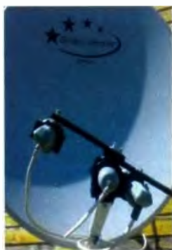
Na jednu parabolickou anténu lze umístit i více konvertorů (LNB) pro příjem různých satelitů bez natáčení antény (tzv. multifeed ). I s tím vám program SatHunter pomůže
