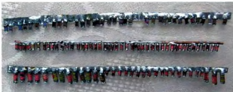
Obr. 7. Zásobníčky kondenzátorů SMD. Součástky jsou připájené na pásky z tenkého železného pocínovaného plechu (železo špatně vede teplo, takže při odpájení jednoho kondenzátoru se neodpájejí sousední kondenzátory)
