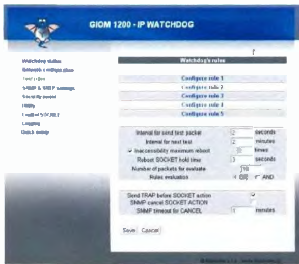
IP watchdog má podrobné webové konfigurační a ovládací rozhraní
