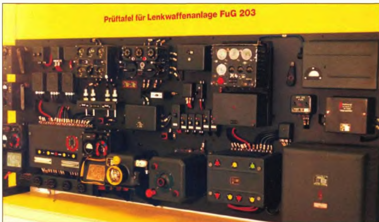
Obr. 16. Kompletní testovací zařízení FuG 203 pro řízenou střelu Fritz X
