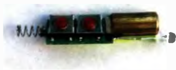
Obr. 38. Rozobraté laserové ukazovadlo
