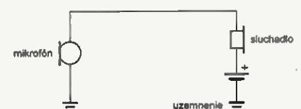
Obr. 31. Princíp poľného telefónu. Miesto druhého vodiča sa používa uzemnenie
