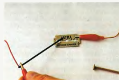
Obr. 29. Miesto diódy postačí k detekcii aj tuha a žiletka
