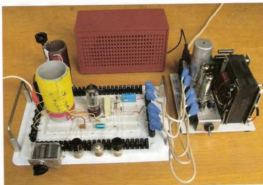
Obr. 11. Ověřování funkce reflexního jednoelektronového přijímače na ED
