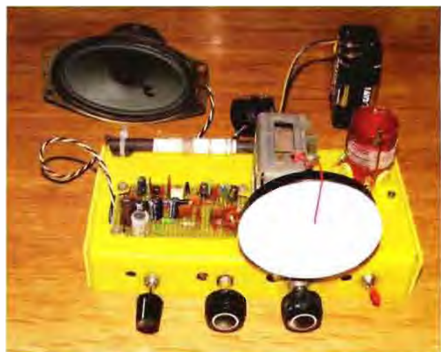
Obr. 2. Příklad konstrukce zpětnovazebního přijímače. Na fotografii je verze pro příjem SV a KV, která bude popsána v dalších číslech
