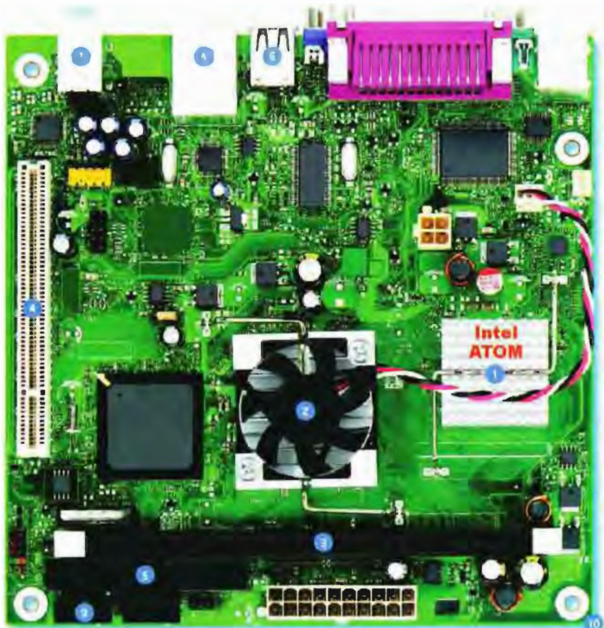
Základní deska rozměru ITX (170x170 mm) s procesorem Intel Atom
