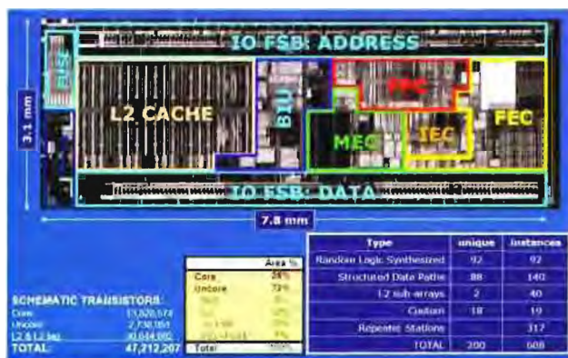
Uspořádání procesoru Intel Atom
