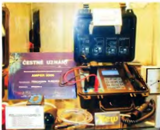
Obr. 4. Oceněný přenosný přístroj PU294 je určený k revizím nejen obvyklých elektrických spotřebičů, ale též zdravotnických elektrických zařízení podle norem ČSN 331600, 331610 a EN60601-1. Vyznačuje se velkou přesností měřených hodnot v širokém rozsahu, oboustrannou možností komunikace s PC, paměti pro 10 000 naměřených hodnot, grafickým LCD displejem s podsvícením a má vestavěný i hodiny. Doplněk PD294 rozšiřuje jeho použití i na oblast třířávkových spotřebičů. Rozměry jsou 270 x 240 x 130 mm, hmotnost 4 kg. Další doplňky umožňují jednak ověření správné funkce, snímání čárového kódu, měření otáček, teploty, proudu do 20 A klešťovým ampérmetrem a speciální přípravek pro revize zdravotnických přístrojů z hlediska tzv. unikajících proudů.
