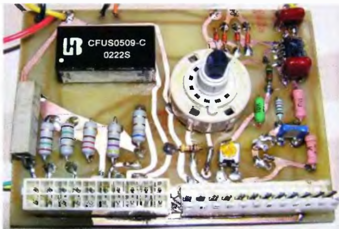
Obr. 10. Osazená vývojová deska
