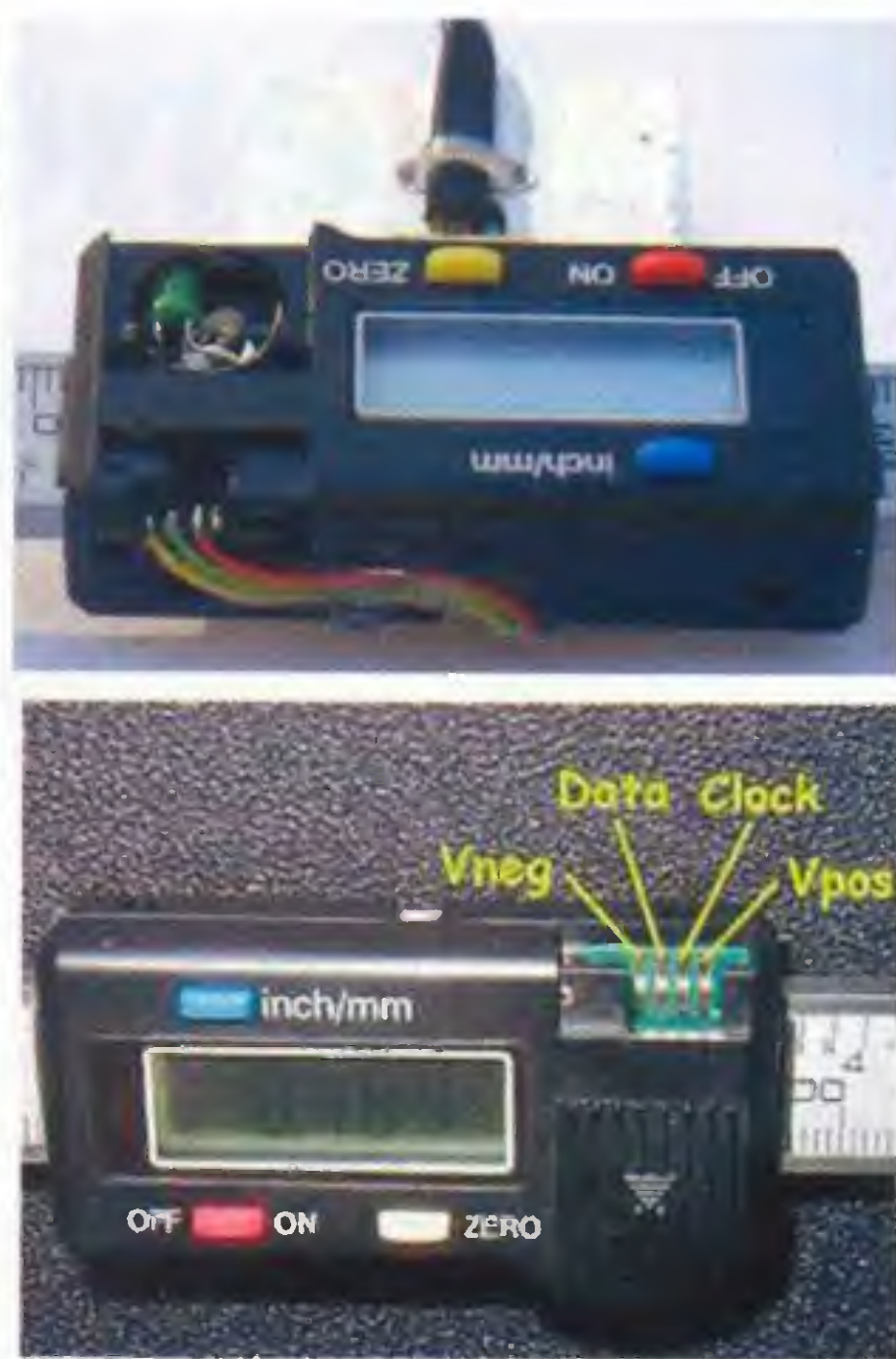
Obr. 3, 4. Zapojení konektorů (Vneg znamená GND a Vpos je +1,5 V)
