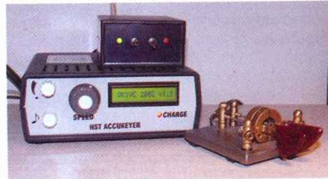
Obr. 2. V roce 2002 Franta zkonstruoval a vyrobil pro české reprezentační družstvo v rychlotelegrafii sadu těchto vynikajících elbugů. Když ho zapnete, na vteřinu na vás mrkne nápis: OK1WC 2002 v1.1 (pastička na snímku je z dílny Slávka, OK1TN - firma ZACH, foto OK1PFM)
