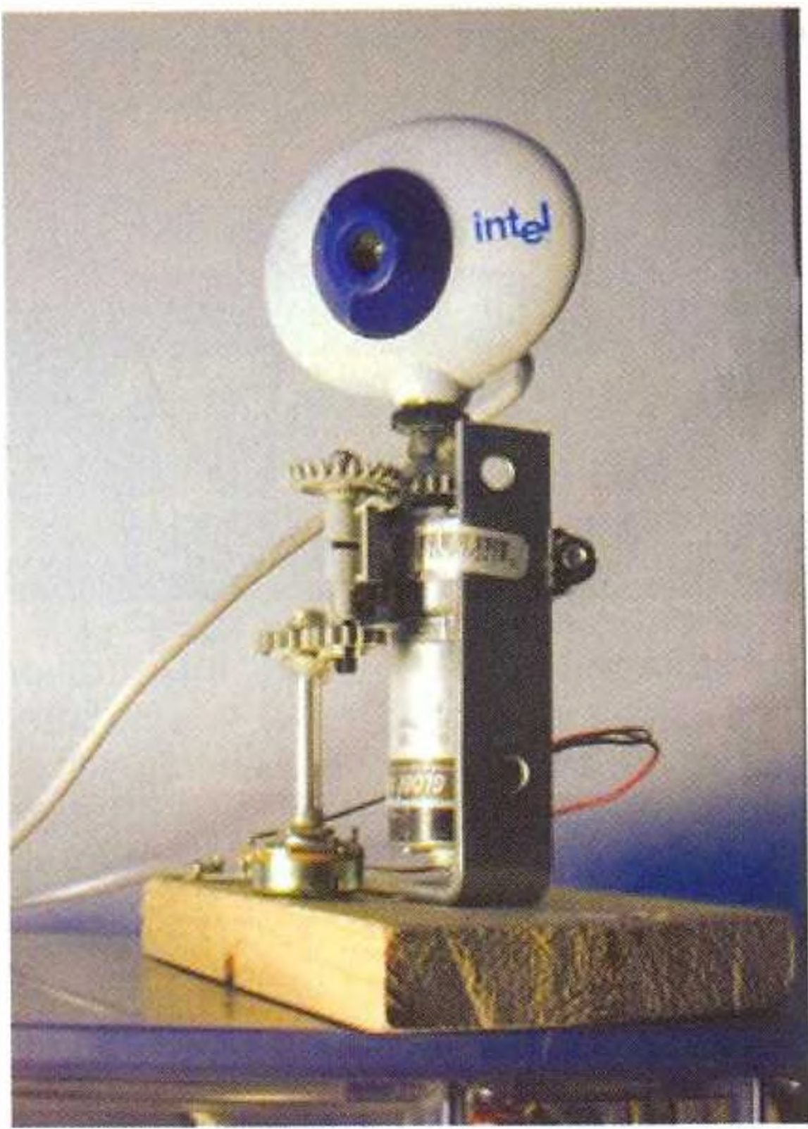
Obr. 1. Jednoduchá webová kamera na dálkově ovládaném natáčecím mechanismu
