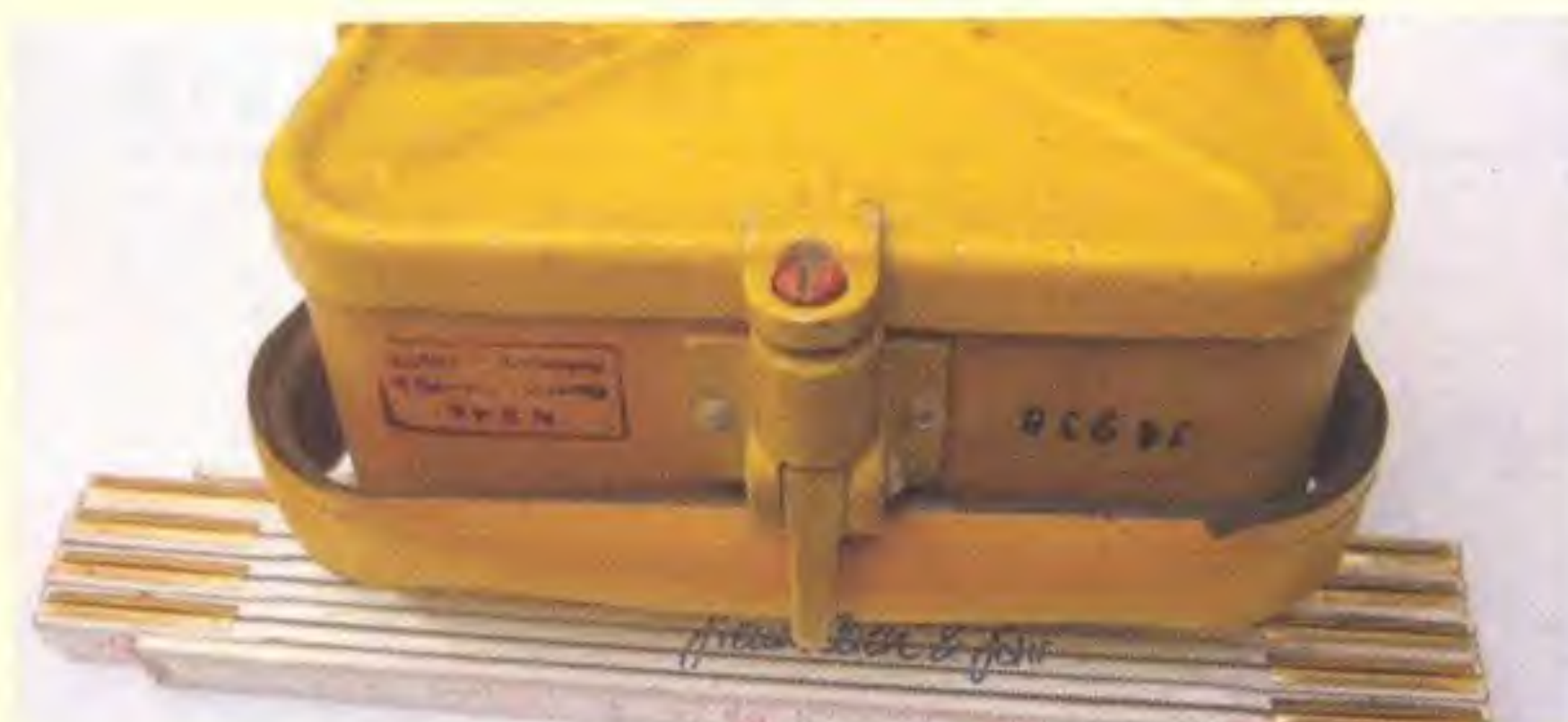
Obr. 2. Detail s anténou svinutou kolem skříňky
