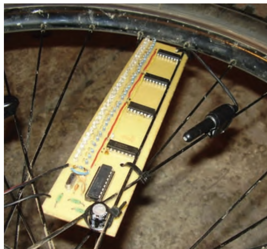
Obr. 7. Ukážka namontovaného displeja na kolese bicykla
