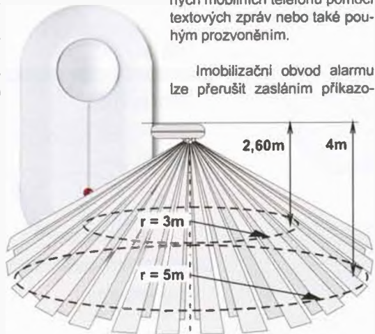
obr. 2 - bezdrátový detektor pohybu JA-85P
