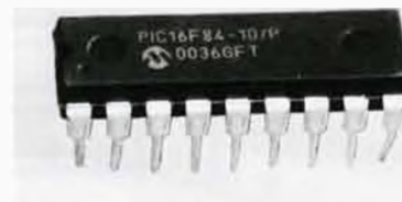
Obr. 1. Mikrokontroléry se svým vzhledem obvykle nijak neliší od běžných integrovaných obvodů
