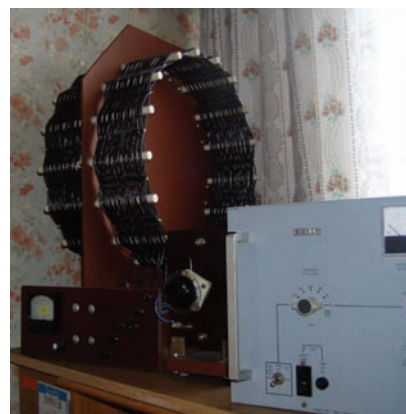
Obr. 1. Koncový stupeň vysílače majáku OK0EMW a přizpůsobovací obvod antény, tvořený dvěma články s měřičem anténního proudu
