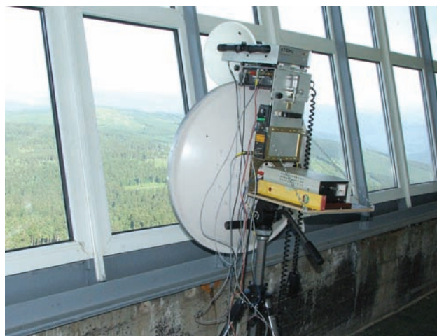
Obr. 2. Zařízení OK1AIY pro 24 a 47 GHz, QTH Klínovec. Pro 47 GHz je anténa Procorn o průměru 25 cm a výkon asi 10 mW ze zesilovače DB6NT
