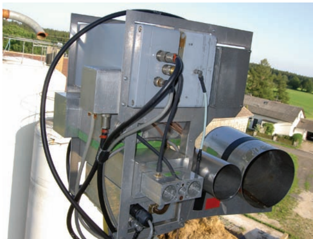
Obr. 1. Soutava transvertorů, která se podle použitého pásma přesouvají do ohniska paraboly o průměru 3 m, kterou OE5VRL používá
