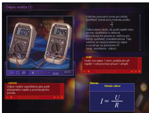
Praktický pokus i zde u Ohmova zákona dokládá, že odpor je opravdu podíl připojeného napětí a procházejícího proudu
