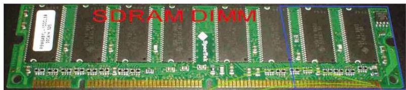
Obr. 14. Vývody SMBUS na paměťových modulech DRAM a SDRAM
