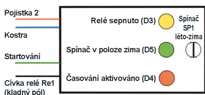
Obr. 4. Přední panel automatu pro spínání světel automobilu
