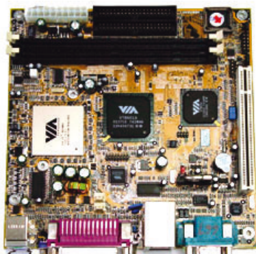
Obr. 2. První deska standardu Mini-ITX o rozměrech 170x170 mm
