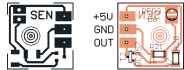
Obr. 4. Deska s plošnými spoji snímače
