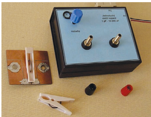
Fotografie mechanického provedení přípravku pro měření součástek SMD
