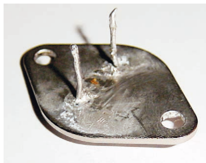
Obr. 2. Přípravek pro měření svodových proudů mezi vývody tranzistorů
