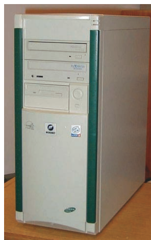
Obr. 5. Počítač je umístěn ve skříni Morex s posuvným krytem, kterým lze zakrýt přístup k mechanikám
