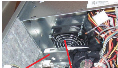
plechová přepážka přidavný ventilátor
