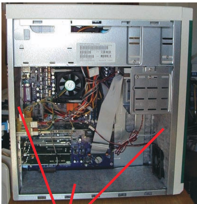
skříň počítače je vylepena tlumičí hmotou
