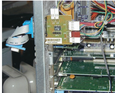
Obr. 12. Karta inteligentní regulace teploty a její umístění
