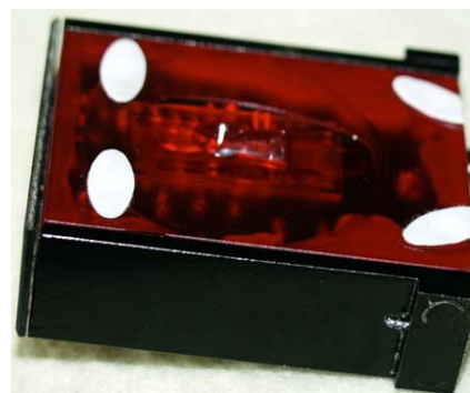
Obr. 19. V hliníkovém pouzdru černé barvy je umístěn senzor IRC-M zalitý v PVC nebo upevněný na distančních sloupcích. Bílé eliptické PVC plošky lehce kloužou po povrchu plochy snímacího kotouče. Pouzdro je vyrobeno z Al trubky čtvercového průřezu 50 x 50 x 3 mm
