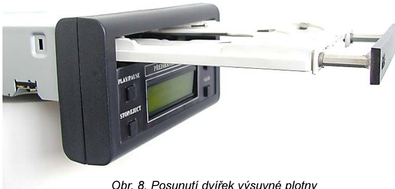
Obr. 8. Posunutí dvířek výsuvné plotny
