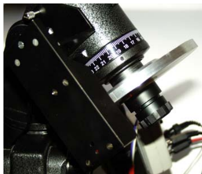
Obr. 21. Umístění a upevnění senzoru IRC-M na obvodu snímacího kotouče osy Ra montáže GS 300. Senzor snímá jemně zdrsněný povrch obvodu kotouče a inkrementálně generuje počet pulsů úměrný délce snímané (ujeté) dráhy po válcové ploše
