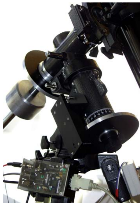
Obr. 23. Celkový pohled na montáž GS 300 doplněnou o snímací kotouče o průměru 127,32 mm na osách RA i DE. Jemně zdrsněný povrch obvodu kotoučů snímají dva senzory IRC-M generující pulsy, jejichž počet je úměrný délce snímané dráhy. V dalších člancích řetězce se snímaná dráha transformuje na úhel otočení osy dalekohledu. Modul NAVIGATOR-1 vyhodnocuje signály ze senzorů a po sériovém kanálu zajišťuje komunikaci s počítačem PC, který vypočítá polohu dalekohledu a promítne ji na mapu hvězdné oblohy. Modul NAVIGATOR-1 je pomocí suchého zipu umístěn na stojanu dalekohledu v levé spodní části obrázku
