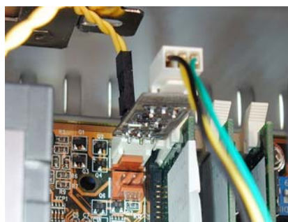
Obr. 10 a 11. Instalace regulátoru na základní desce počítače
