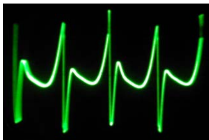
Obr. 2. Průběh napájecího proudu ventilátoru
