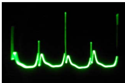
Obr. 3. Průběh napájecího proudu jiného ventilátoru
