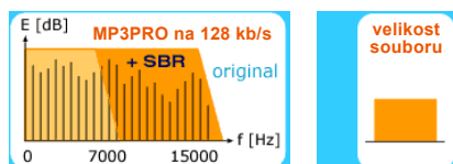
Obr. 3. Přenášená nf šířka pásma a velikost souboru u MP3PRO při 64 kb/s
