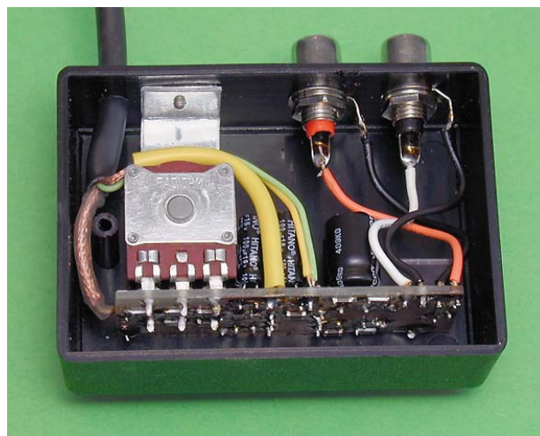
Obr. 4 a 5. Osazená deska zesilovače a umístění desky v krabičce
