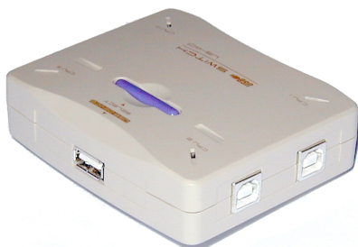
Obr. 9. Přístrojek pro pohodlné přepínání jednoho periferního zařízení USB mezi až 4 počítači
