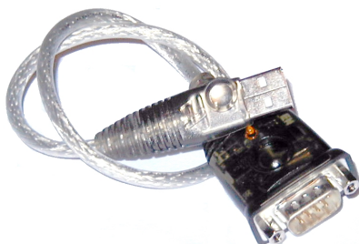
Obr. 3. Adaptér sériového portu přes rozhraní USB
