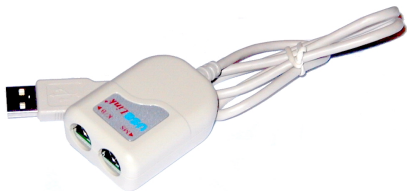
Obr. 7. Adaptér pro vytvoření dvou portů PS/2 přes rozhraní USB
