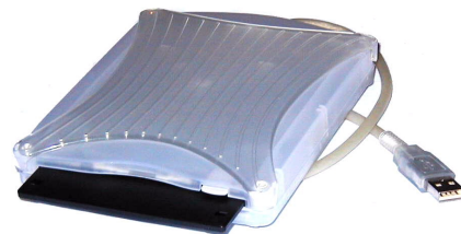
Obr. 5. Disketová jednotka 3,5" připojovaná i napájená přes USB
